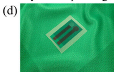
(d) After heat transfer printing
