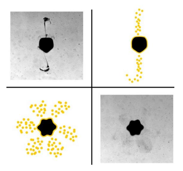
Local release, assisted by an acoustic trap, of nanoparticles transported by microbubbles. Credit: Diego Baresch, Institut de mécanique et d'ingénierie de Bordeaux (CNRS/Université de Bordeaux/Arts et Métiers Paristech/Bordeaux INP)
