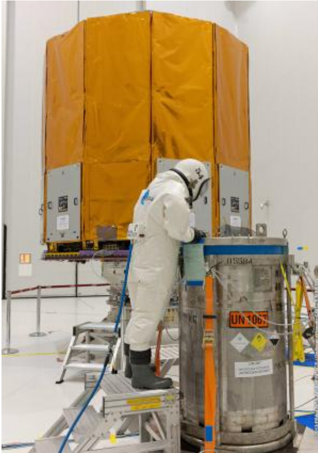
Filling of the Gaia spacecraft fuel tanks. Credit: ESA-CNES-Arianespace / Optique Vidéo du CSG - S. Martin
