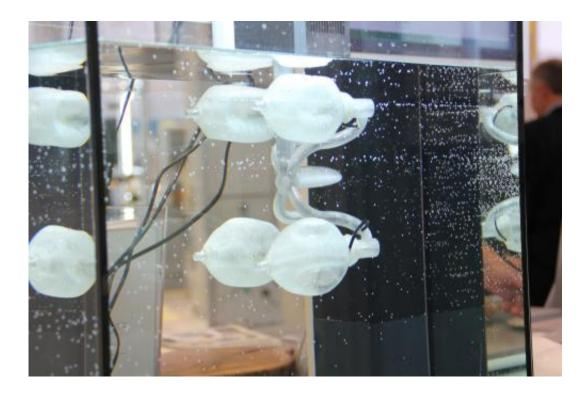
Vier elastische Kunststoffbälle pumpen Wasser und sorgen so für den erforderlichen Vortrieb. Das Antriebssystem wurde mit dem generativen Fertigungsverfahren Fused Deposition Modeling hergestellt. Credit: Fraunhofer IPA
